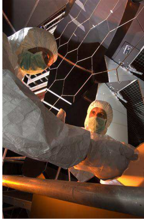
Installation des miroirs sphériques de haute précision dans l'enceinte (H : 7m x L : 10m x P : 2.5m) du détecteur RICH2 de l'expérience LHCb, auprès du LHC au CERN. Ces miroirs vont focaliser sur les détecteurs de photons le rayonnement Cherenkov créé par les particules chargées qui traverseront le détecteur © CERN
