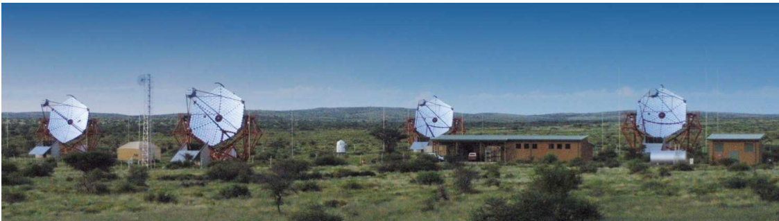
Les 4 paraboles de HESS « High Energy Stereoscopic System » constituent un télescope atmosphérique Cherenkov, situé à une altitude de 1800 m en Namibie. Les sources astronomiques de rayons gamma sont découvertes grâce aux gerbes de particules chargées, produites dans la haute atmosphère © HESS
