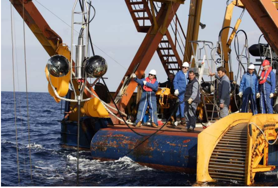
ANTARES, télescope sous-marin qui détecte le passage des neutrinos grâce à l'effet Cherenkov dans l'eau de mer à une profondeur de 2500 m au large de Toulon © ANTARES, Lorette Fabre
